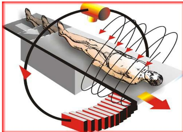
**Slika 13.** Shema spiralnog CT uređaja (izvor:
