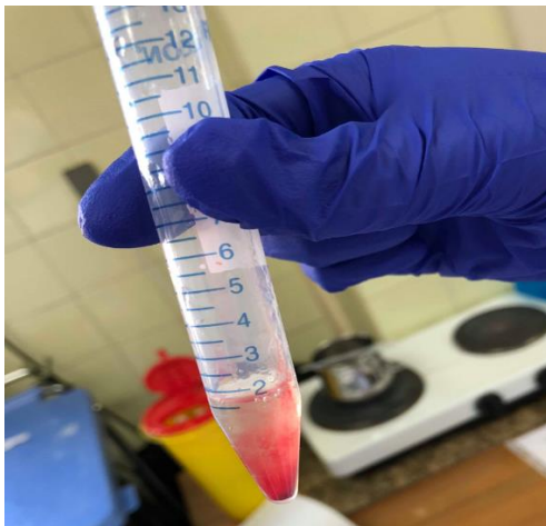
Slika 4. Dodavanje agara na sediment uzorka
