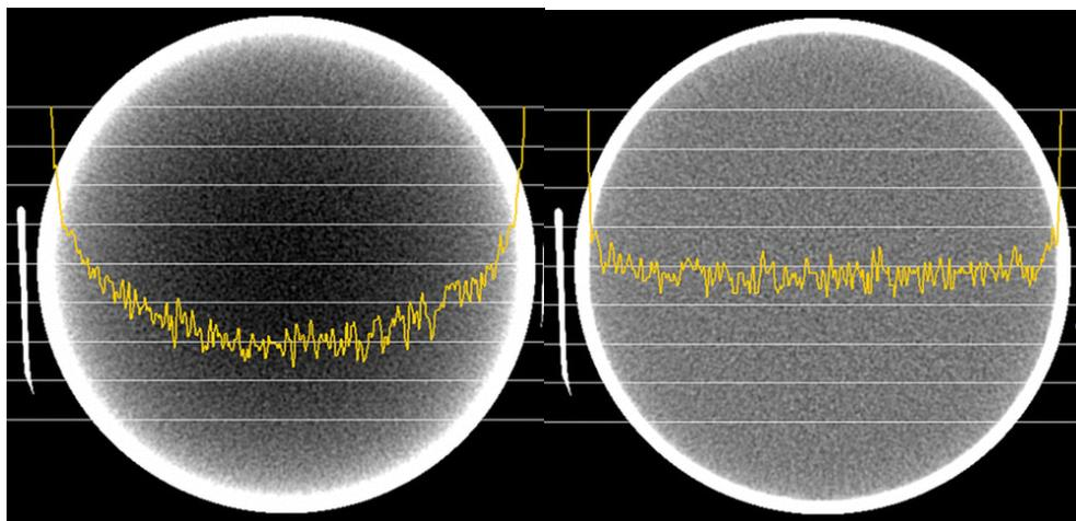
Slika 7. Prikazuje se karakterističan kupolast oblik „cupping“ artefakta na slici lijevo zajedno s CT brojevima bez kalibracijske korekcije i s kalibracijskom korekcijom na slici desno. [13.]
