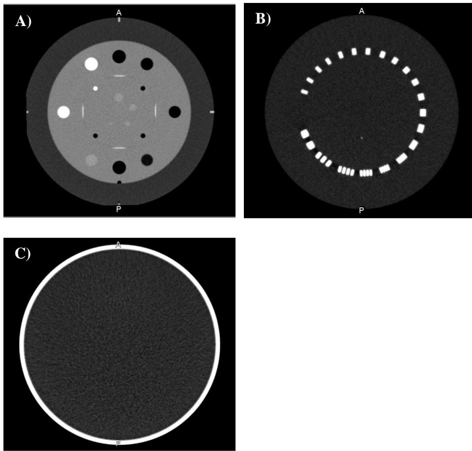
Slika 4. „Imaging“ fantom na CATPHAN 504 na CT-u. Na slici A se provjerava kontrastna rezolucija, debljina sloja, točnosti lasera te kalibracija CT broja odnosno senzitometrija, B postorna rezolucija te na C uniformnost odnosno šum. [Slikovni materijal Kliničkog zavoda za dijagnostičku i intervencijsku radiologiju KBC Split]
