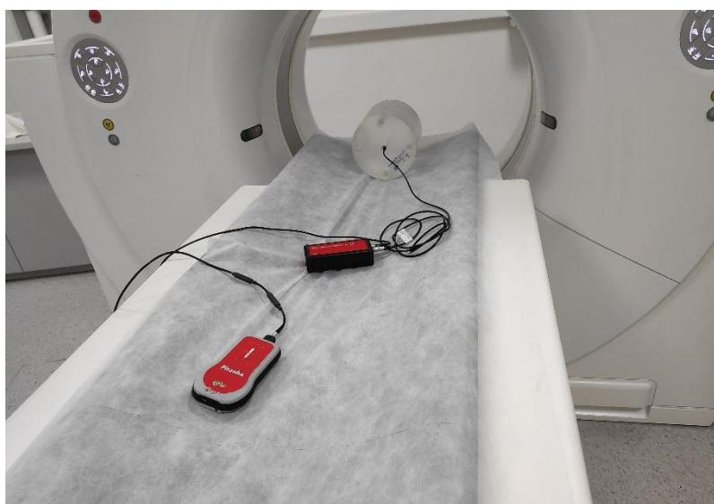
Slika 15. Voden fantom s ionizacijskom komorom u položaju za skeniranje. [Slikovni materijal Kliničkog zavoda za dijagnostičku i intervencijsku radiologiju KBC Split]
