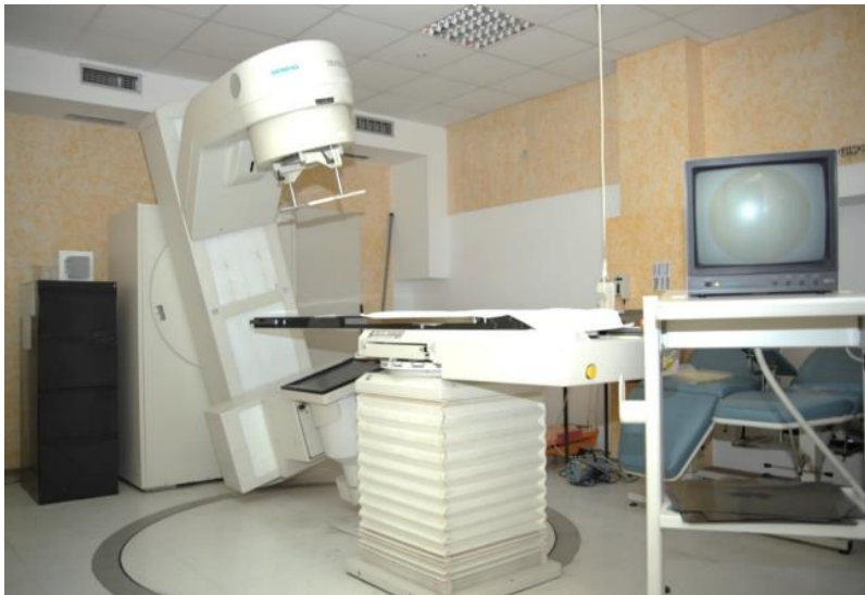
Slika 2. Klasični radioterapijski simulator (preuzeto sa:
