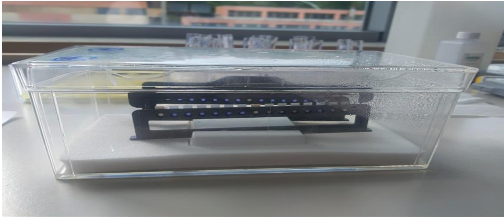
Slika 7. Aplikatori s razrijeđenim serumima u vlažnoj komori
