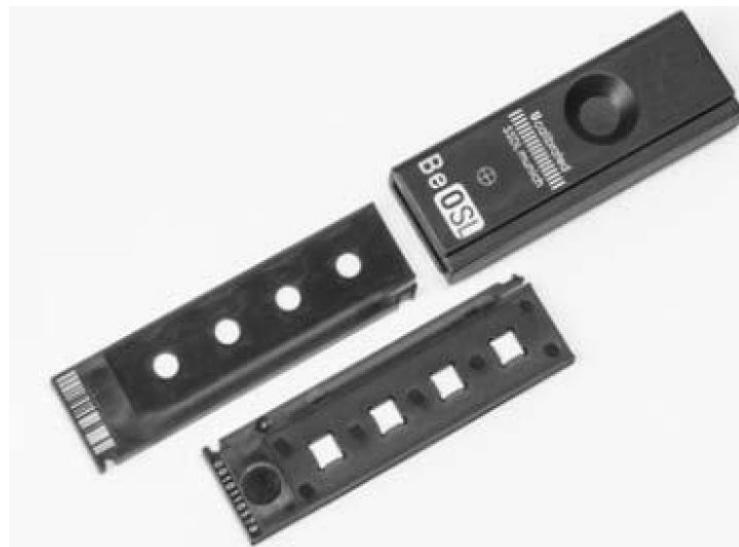
Slika 10. Dozimetar na bazi optički stimulirane luminiscencije
