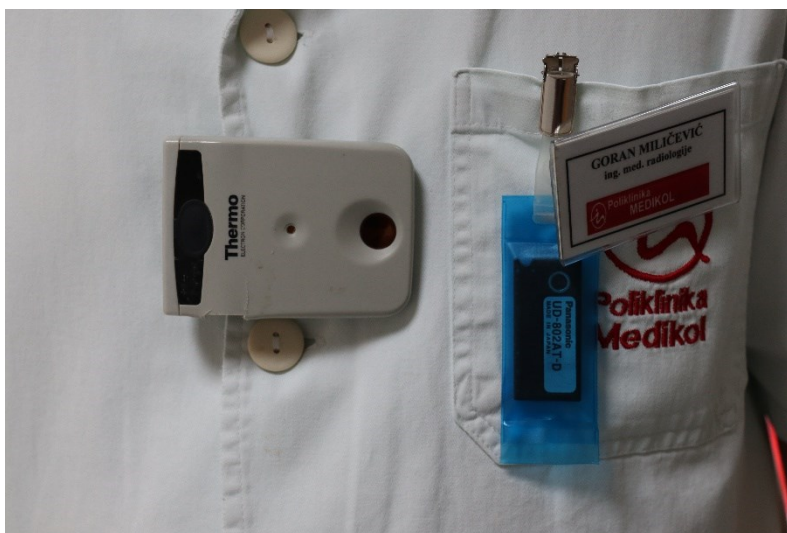
Slika 11. Način nošenja TLD dozimetra Hp 10 i elektronskog dozimetra Hp 7
