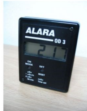
Slika 7. Aktivni elektronički dozimetri
