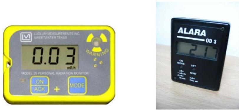
Slika 7. Aktivni elektronički dozimetri
