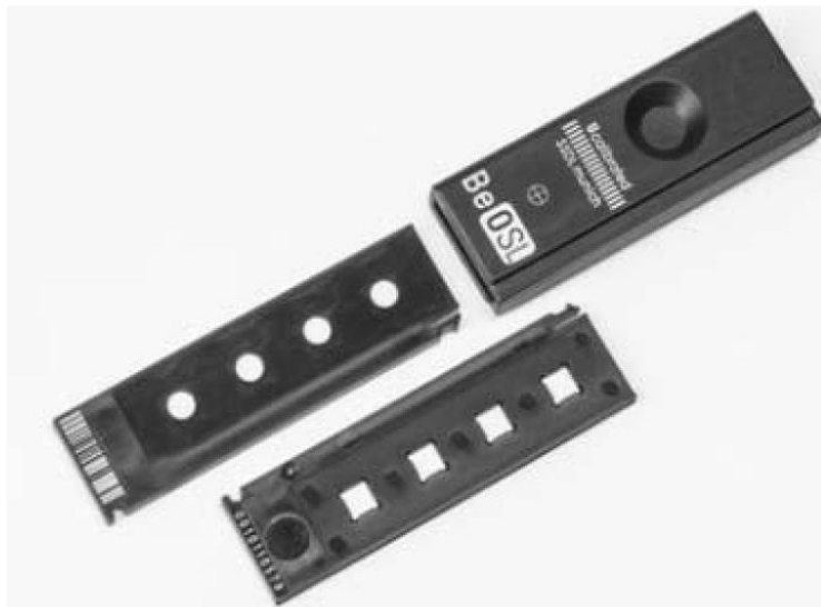
Slika 10. Dozimetar na bazi optički stimulirane luminiscencije
