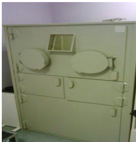
Slika 8. Uređaj za automatsko navlačenje FDG-a.
