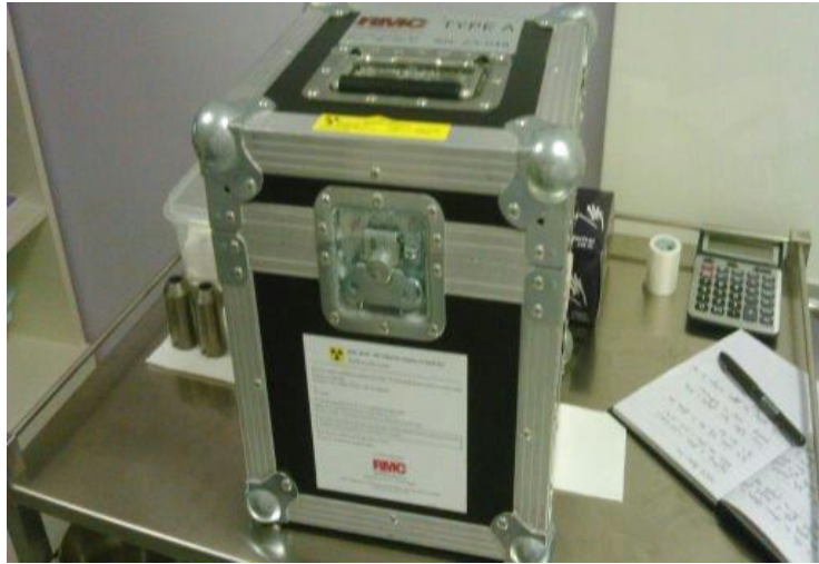
Slika 6. Olovni spremnik u kojoj se prenosi FDG.
