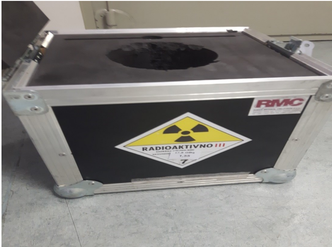
Slika 8. Olovni spremnik u kojem se vrši transport radiofarmaka. Izvor: Poliklinika Medikol Split
