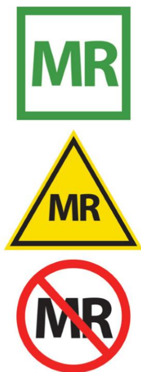
Slika 12. Oznake za prijenosne uređaje koji mogu ulaziti u zonu IV. Zeleno sigurno žuto uvjetno, crveno zabranjeno
