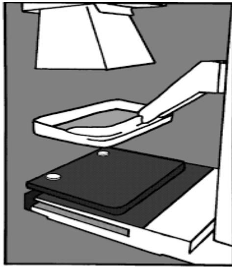
Slika 3. Test poravnavanja polja zračenja
