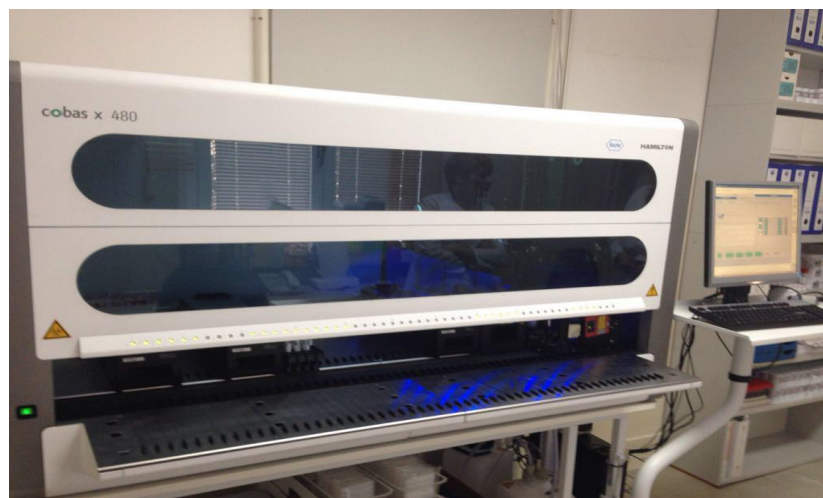
Slika 13. Aparat za izolaciju DNA – Roche cobas x 480
