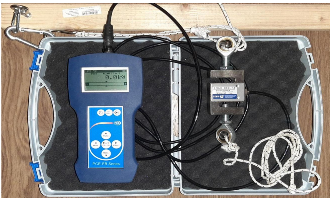
Slika 9. Prikaz dinamometra i svih dodataka za mjerenje snage ispitanika
