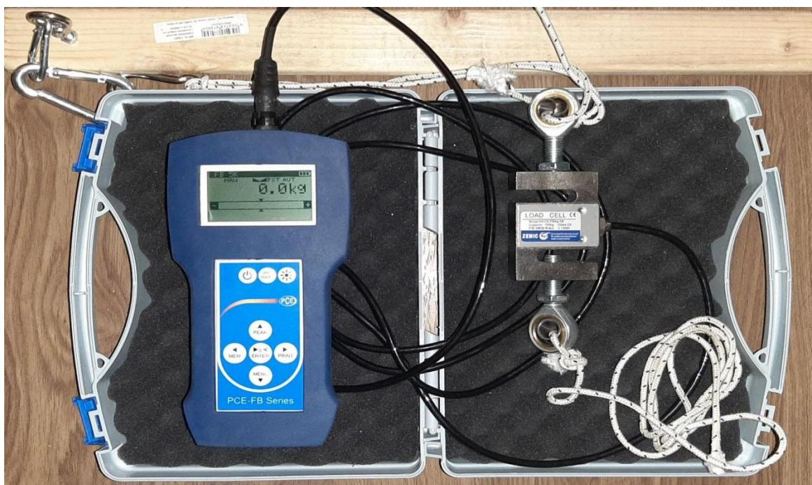
**Slika 9.** Prikaz dinamometra i svih dodataka za mjerjenje snage ispitanika
