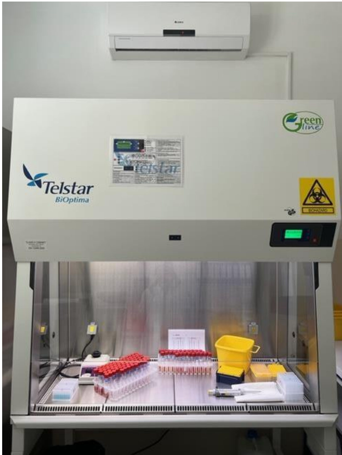
Slika 11 Sigurnosni kabinet za pripremu uzoraka (Nastavni zavod za javno zdravstvo SDŽ, 2022.)
