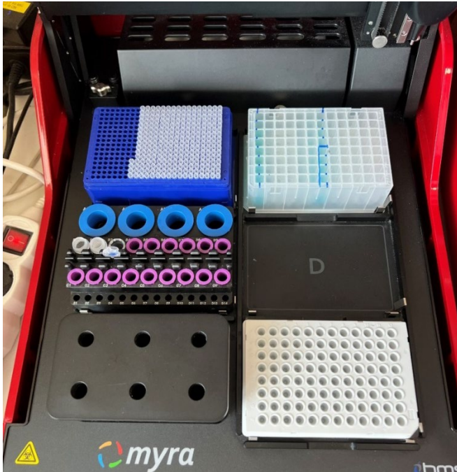
Slika 28. Myra uređaj za automatsko pipetiranje
