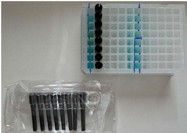
Slika 22. Nastavci za pomicanje magnetskih kuglica adsorbiranih s NK
