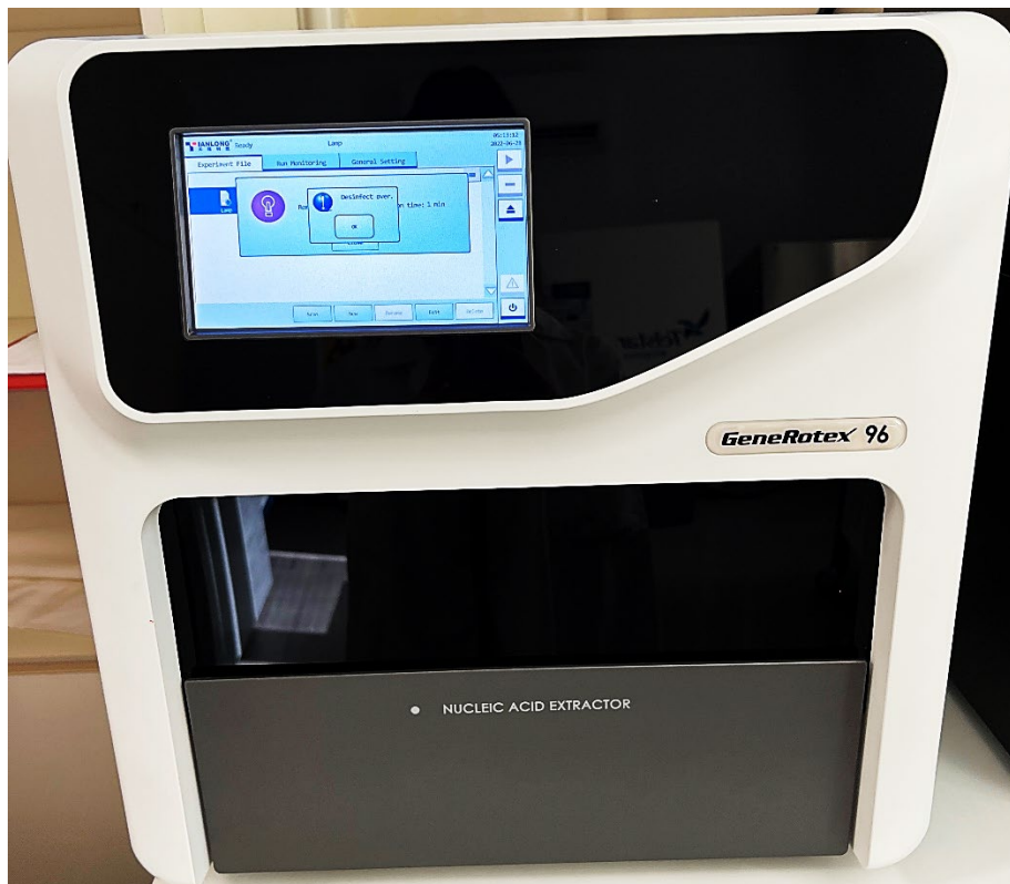
Slika 21. Automatski ekstraktor nukleinske kiseline (GeneRotex 96)
