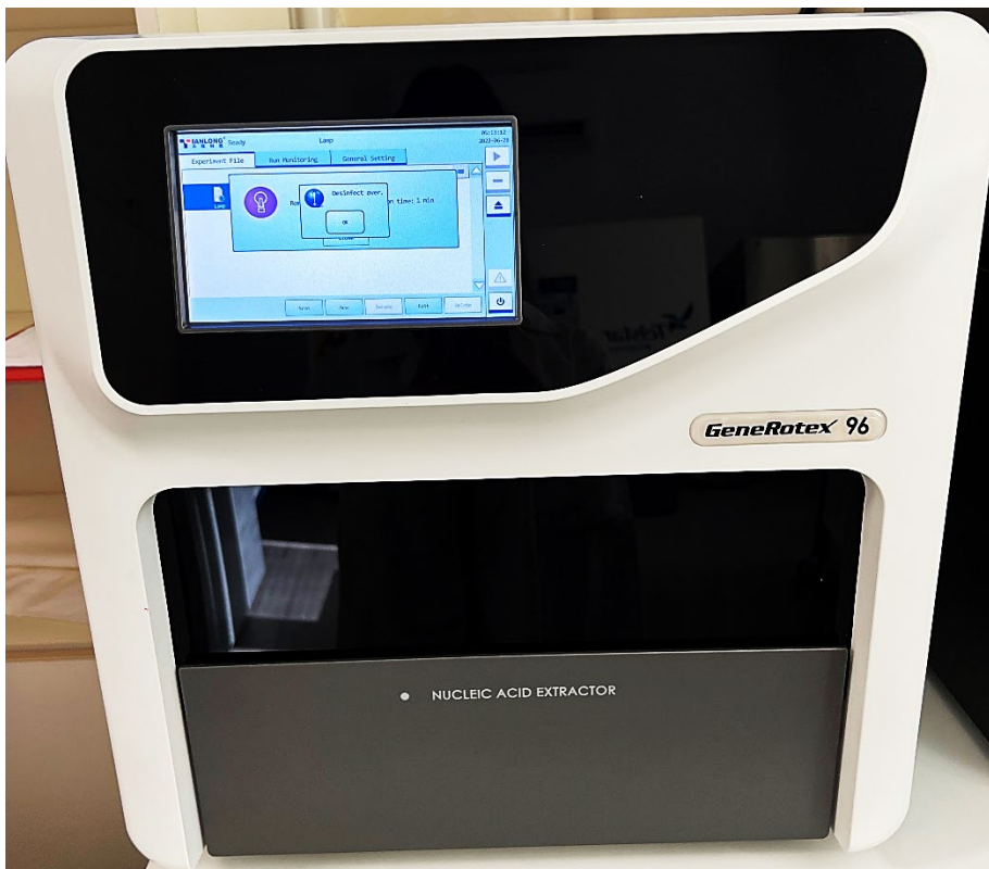
Slika 21. Automatski ekstraktor nukleinske kiseline (GeneRotex 96)
