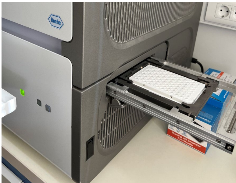
Slika 32. Umetanje mikrotitarske pločice u Cobas z480 analizator
