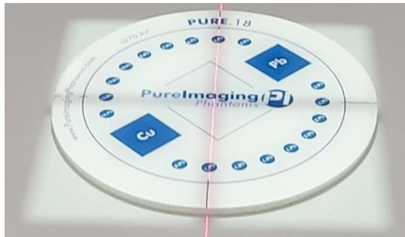
Slika 35 Otvaranje svjetlosnog polja na veličinu fantoma
