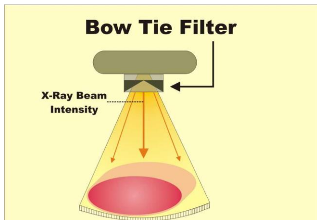
Slika 9. Prikaz bowtie filtra
