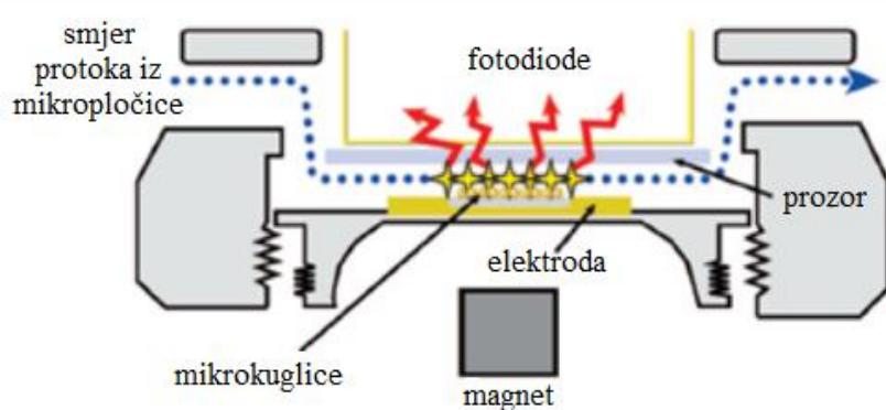
Slika 14. Shematski prikaz sustava za mjerjenje ECL (23)
