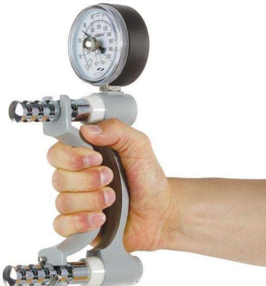
**Slika 7.** Jamarov dinamometar za mjerjenje snage stiska šake
