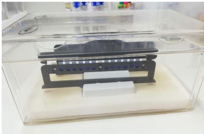
Slika 10. Aplikatori s nanesenim uzorcima u vlažnoj komori.
