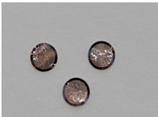
Slika 25. Mrežice od bakra ručno presvučene folijom otopine Formvar
