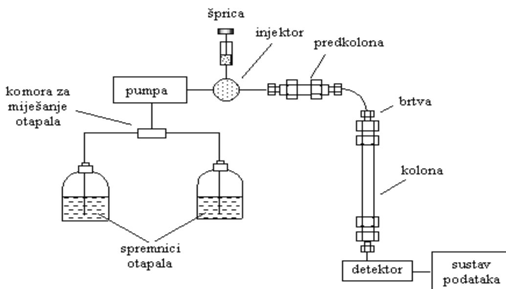
Slika 6. Shematski prikaz HPLC uređaja
