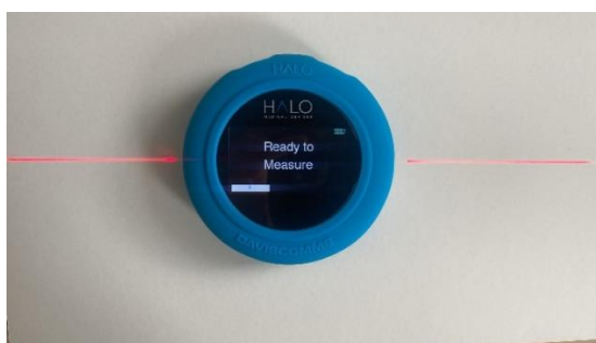
Slika 6. Digitalni goniometar (Halo digital goniometar) – uređaj za provođenje mjerenja opsega pokreta u zglobu
