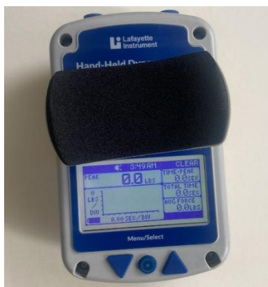
Slika 7. Ručni dinamometar Lafayette (engl. Hand – held Dynamometer ) za mjerenje snage mišića
