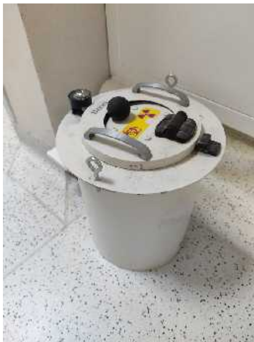
Slika 14. Spremnik za kontaminirani otpad (Izvor: Filip Samardži )
