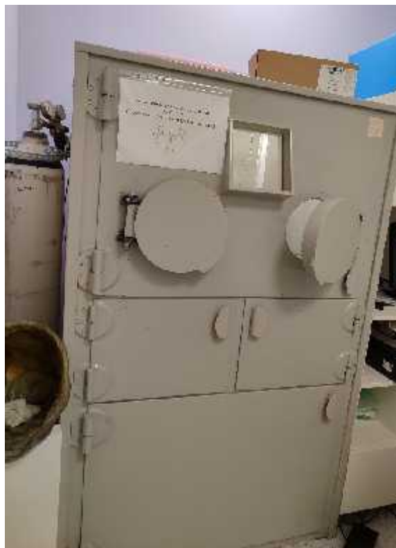
Slika 13. Olovni ormar za pohranu i rad s radiofarmacima (Izvor: Filip Samardži )
