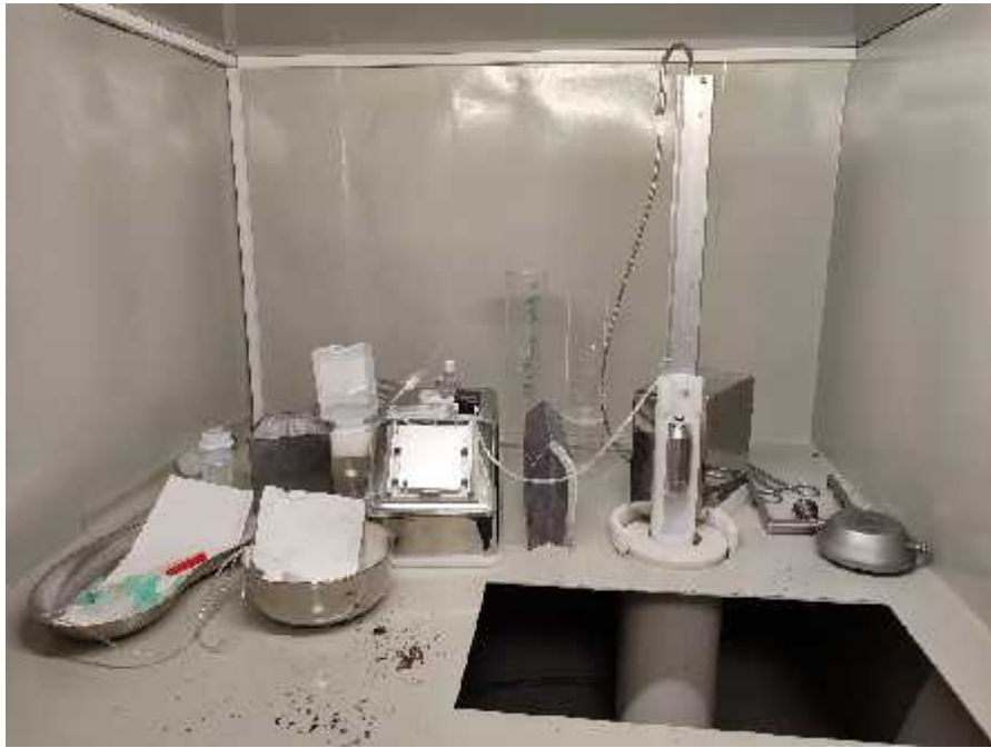
Slika 11. Sustav za navla enje radiofarmaka (Izvor: Filip Samardži )
