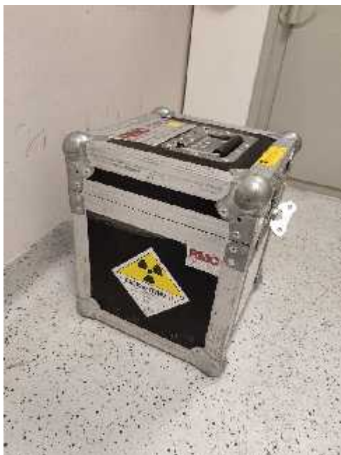
Slika 8. Transportni kontejner za FDG (izvor: Filip Samardži )
