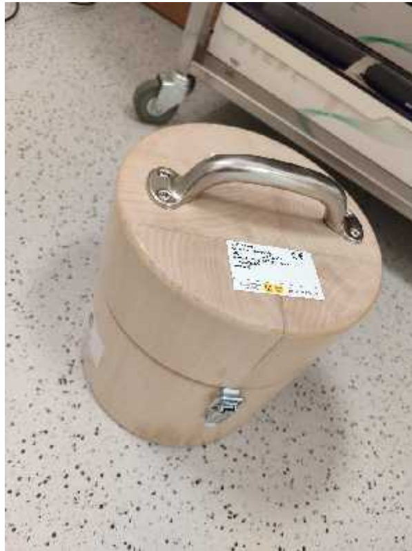
Slika 7. Spremnik Cs-137 (izvor: Filip Samardži )
