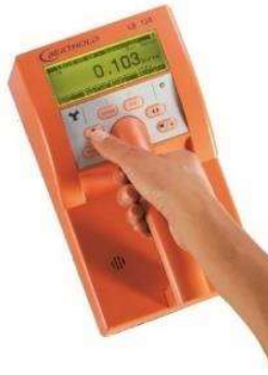
Slika 8. Monitor za mjerenje površinske kontaminacije
