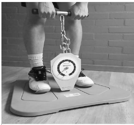
Slika 13. Prikaz fiksnog dinamometra
