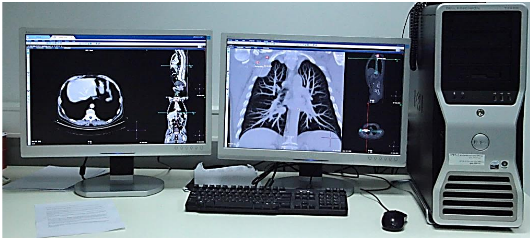
Slika 18. Radna stanica za obradu i evaluaciju slika s CT uređaja (Izvor: Dr. sc. F. Mihanović)
