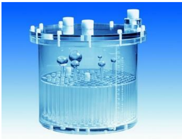
Slika 9. Jaszczak-ov SPECT fantom
