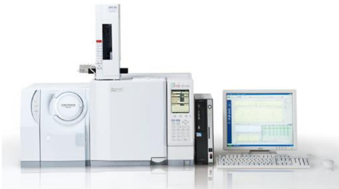
Slika 3. Plinski kromatograf sa spektrometrom masa; Shimadzu GCMS-QP2010
