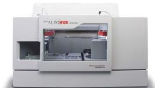
Slika 6. Aparat Auto/Vue Innova za imunohematološko testiranje (Preuzeto s: http://www.orthoclinical.com/en-be/about-us/newsroom )
