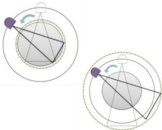
Slika 4. Shematski prikaz uređaja četvrte generacije; izvor:
