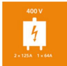
Spremnik snage: Velika ulazna snaga se pretvara u dvostruku visoku izlaznu snagu pomoću Power Buffera ili spremnika snage. Pojedinačno napajanje svake rendgenske cijevi zahtijeva više infrastrukture što može ograničavati Dual-Source tehnologiju, a na ovaj način je taj problem riješen.
