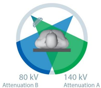
Slika 8. Shematski prikaz Dual-Source Dual-Energy CT uređaja; izvor:
