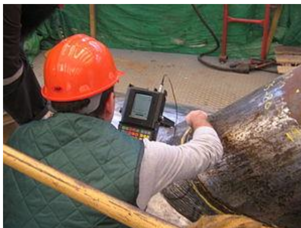
Slika 2. Ultrazvučna kontrola zavora; Izvor (5)
