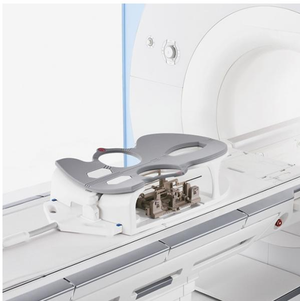
slika 6 – zavojnica za dojku (izvor: <https://www.healthcare.siemens.com/magnetic-resonance-imaging/>)
