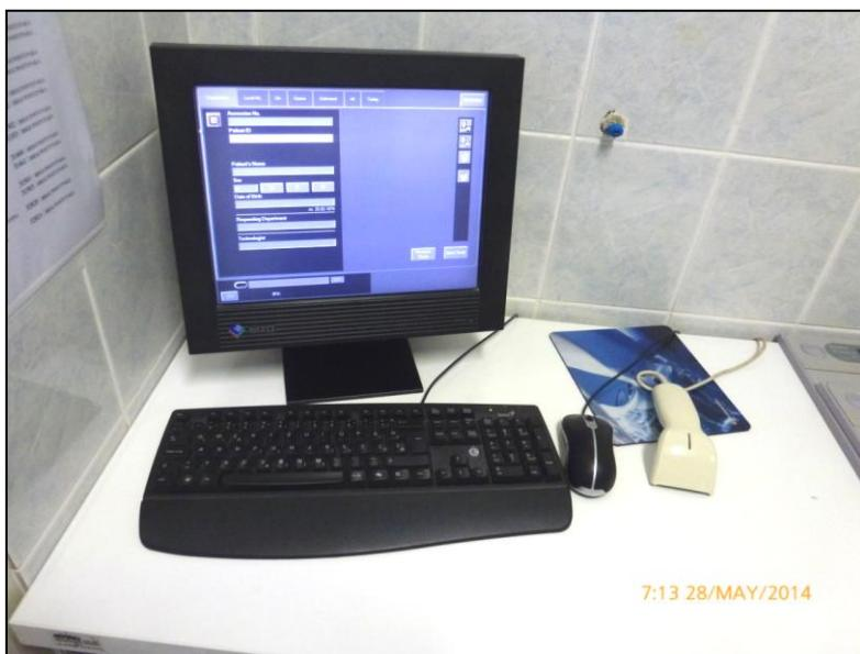
*Slika 7. Računalo za naknadnu obradu slika (engl. post processing) koja je snimljena na fosfornoj ploči*
