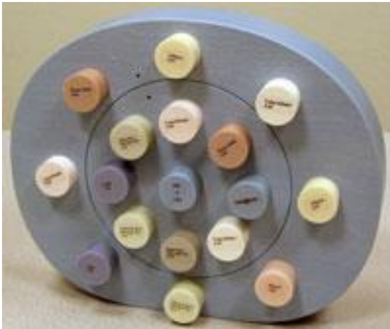
Slika 1. Kalibracijski fantom promjera 33 cm tzv. „pelvis“ fantom te unutrašnji disk za glavu promjera 18 cm koji se može sam skenirati. [9.]
