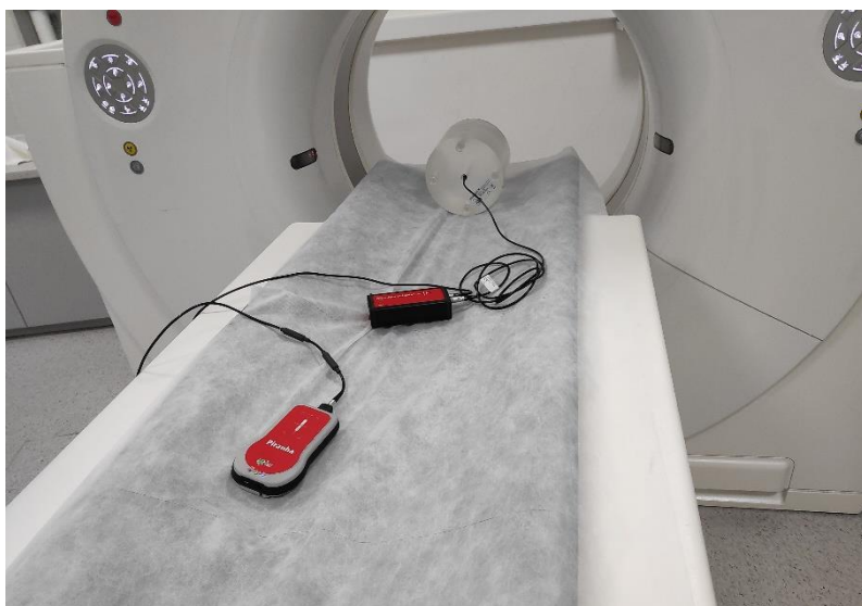
Slika 15. Vodeni fantom s ionizacijskom komorom u položaju za skeniranje. [Slikovni materijal Kliničkog zavoda za dijagnostičku i intervencijsku radiologiju KBC Split]
