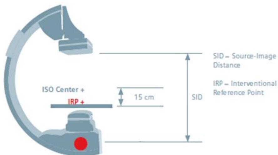
Slika 10. Bitne točke i udaljenosti unutar C-luka
