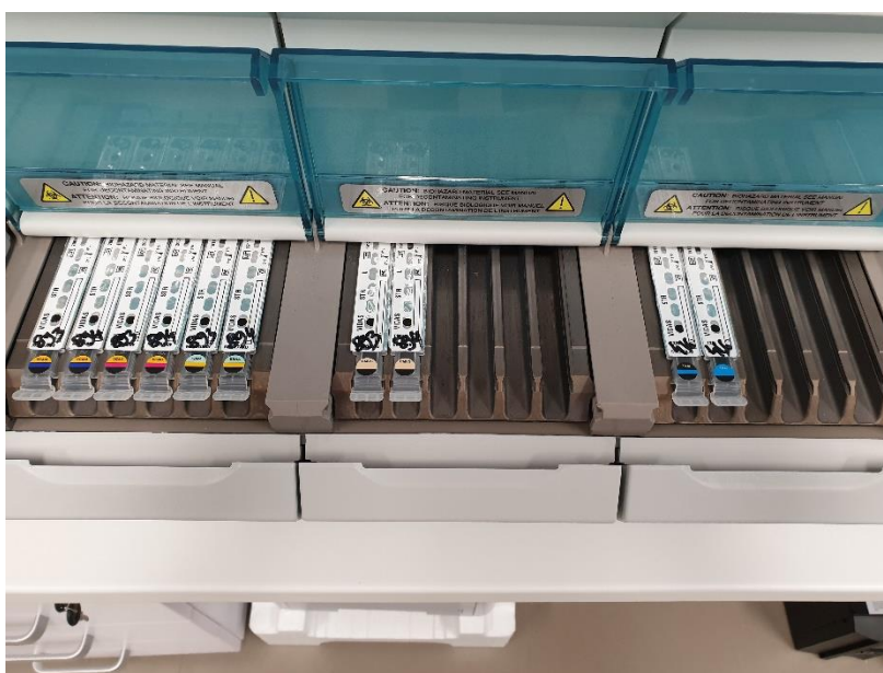
Slika 36. Postupak stavljanja kadica sa serumima u analizator
