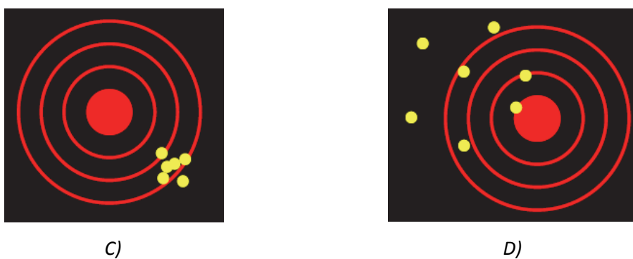
Slika 1.8. C) Sustavna pogreška ( \Sigma ) je velika, a slučajna pogreška ( \sigma ) je mala D) Slučajna ( \sigma ) i sustavna ( \Sigma ) pogreška su velike
