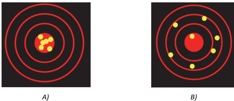
Slika 1.7. A) Slučajna pogreška ( \sigma ) i sustavna pogreška ( \Sigma ) su male B) Slučajna pogreška ( \sigma ) je velika dok je sustavna pogreška ( \Sigma ) mala
