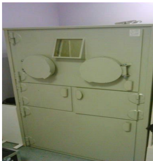
Slika 8. Uređaj za automatsko navlačenje FDG-a.
