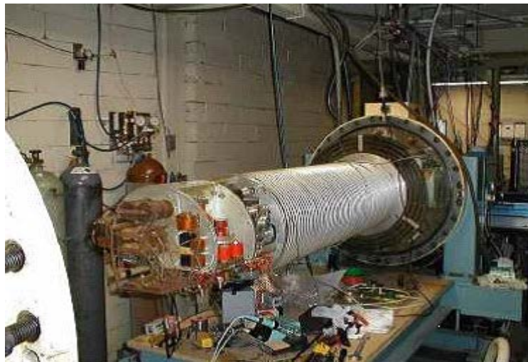
Slika 6. Otvoren Van de Graaffov akcelerator iz 1960-ih godina, koji je mogao postići energiju 2 MeV
