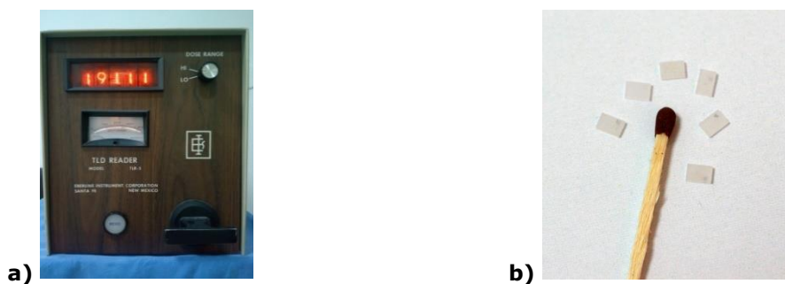
Slika 5. a) TLD čitač Ebeline mod.TLR-5, b) Thermo Scientific™ TLD-700
