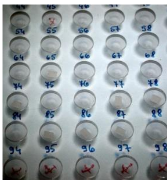
Slika 6. Poredani i označeni TLD na podlozi za kalibraciju
