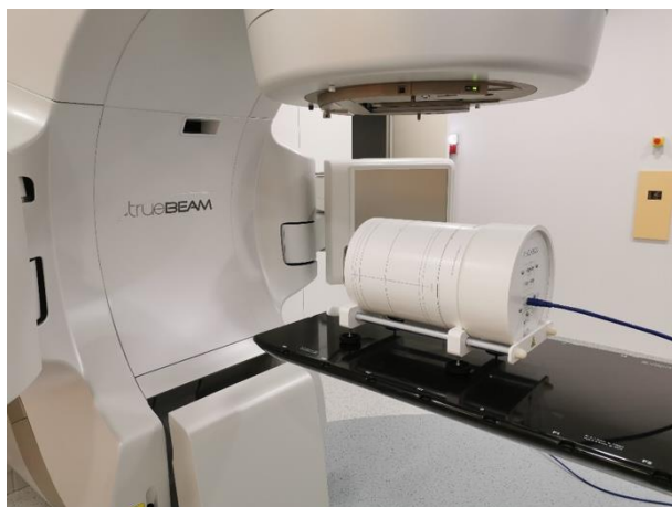
Slika 10. PSQA sa Arc check uređajem
