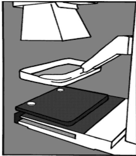
Slika 3. Test poravnavanja polja zračenja
